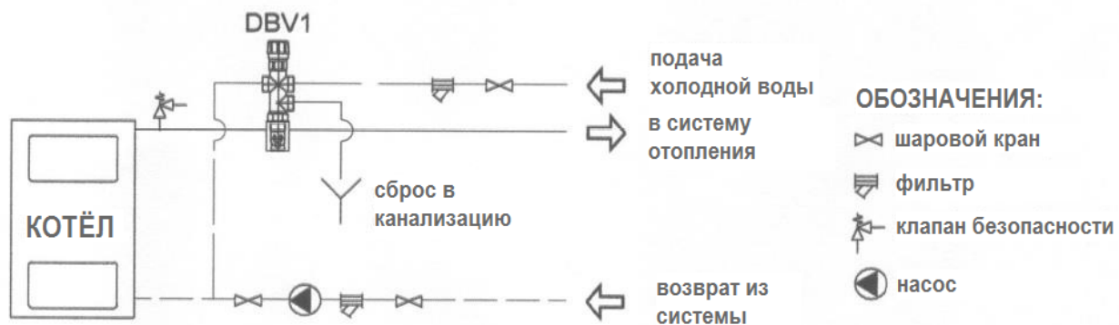
Рис.6 Схема установки с двухходовым клапаном безопасности DBV1.
