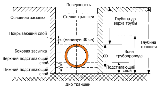
Рис. 3 Устройство траншеи
