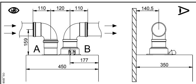
90° отвод позволяет присоединять котел к дымоходу-воздуховоду в любом направлении, адаптируясь к различным требованиям. Кроме того, он может использоваться в качестве дополнительного в сочетании с трубой или с 45° отводом.
