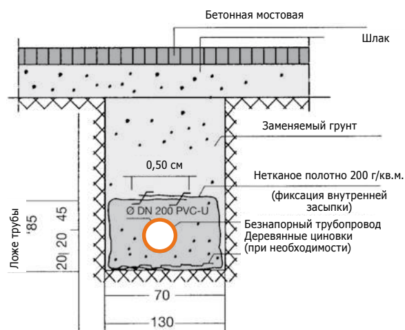
Рис. 7 Пример прокладки труб в мягком грунте
