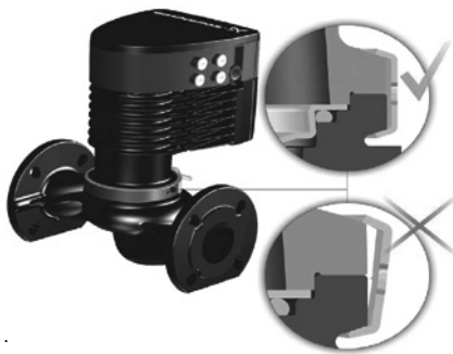
Рис. 16 Закрепление головной части насоса на корпусе насоса
