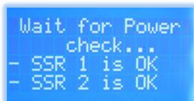
Рис. 7 – Экран проверки питания и твердотельных реле (SSR)
