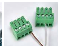
Фото 14. Подключение провода датчика к ответной части разъема
