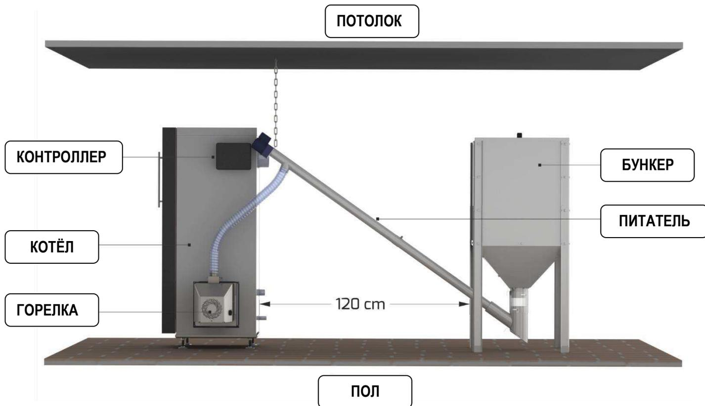
Рис. 7. Схема котельной.
