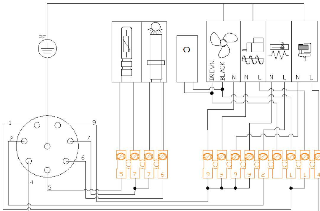
Рис. 14. Электрическая схема моделей от REVO 44 до REVO 150.
