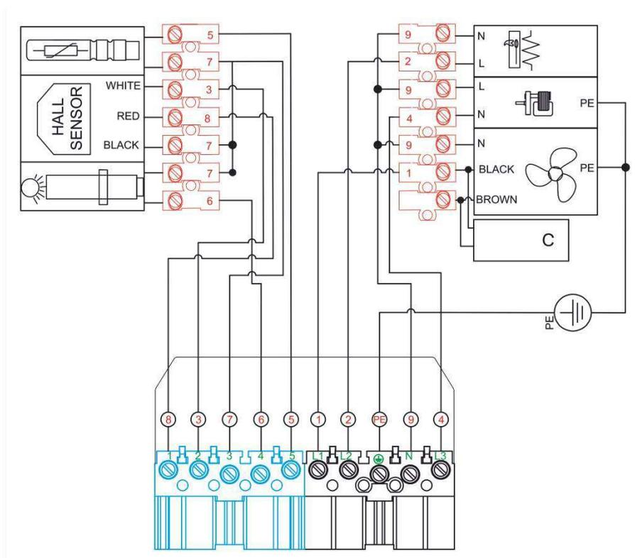
Рис. 13. Электрическая схема моделей REVO Mini и REVO Mini 35.
