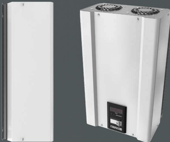
Однофазный стабилизатор напряжения Ампер 9 предназначен для работы в электрических сетях с колебаниями напряжения от 160 до 260В. В этом диапазоне аппарат выдает на выходе напряжение в рамках 220В±4.5%, что обеспечивается за счет использования 9 ступеней стабилизации.
