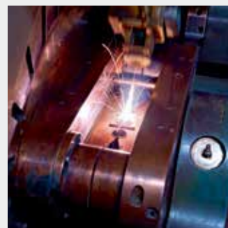
Лазерная сварка коллекторов
