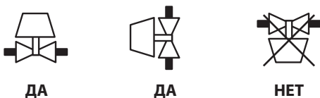
Рис. 3. Рекомендации по ориентации крана в пространстве.
