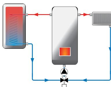
Клапан 3-ходовой переключающий на схеме, изображенной выше, может управляться контроллером или термостатом, датчик которого будет находиться в накопительном баке. В первом случае клапан будет переключать на отопительный контур или контур ГВС в зависимости от выбранного приоритета на контроллере. Во втором может нагревать контур ГВС, если температура воды в нем упадет ниже значения, установленного на термостате.
