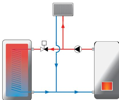
Клапан 2-ходовой запорный на схеме, изображенной выше, в сочетании с термостатом, датчик которого будет размещен в накопительном баке, сохраняет приоритет нагрева потребляемой воды. В тот момент, когда температура воды в накопительном баке упадет ниже значения, установленного на термостате, клапан открывает циркуляцию через резервуар и таким образом очень быстро ее нагревает. После достижения заданной температуры в накопительном баке, клапан закрывается.
