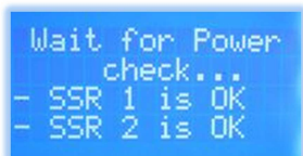
Рис. 7 – Экран проверки питания и твердотельных реле (SSR)
