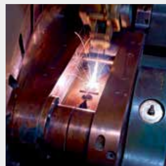
Лазерная сварка коллекторов
