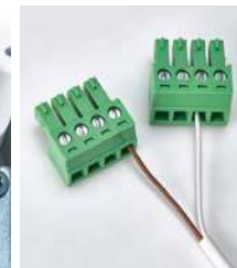
Фото 10. Подключение провода датчика к ответной части разъема электропривода
