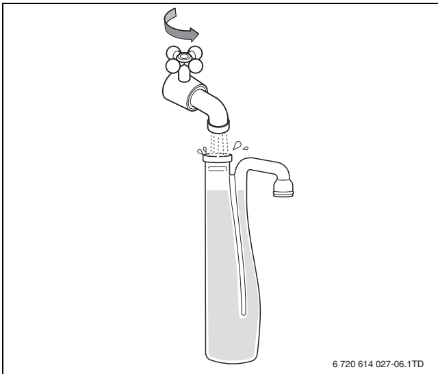
Рис 12 Наполнение сифона водой
