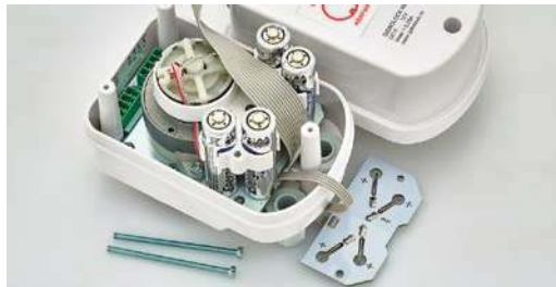
Фото 17. Контактная площадка снята, батарейки могут быть заменены
