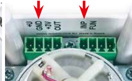
Фото 13. Клеммы подключения проводных датчиков — INP, GND
