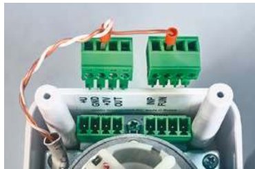
Фото 23. Подключение проводного выключателя
