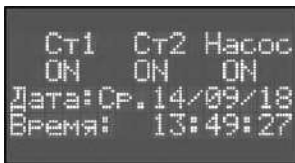
Рисунок 14.35 – Раздел Экран 2 в котле без датчика давления: обе ступени и насос включены
