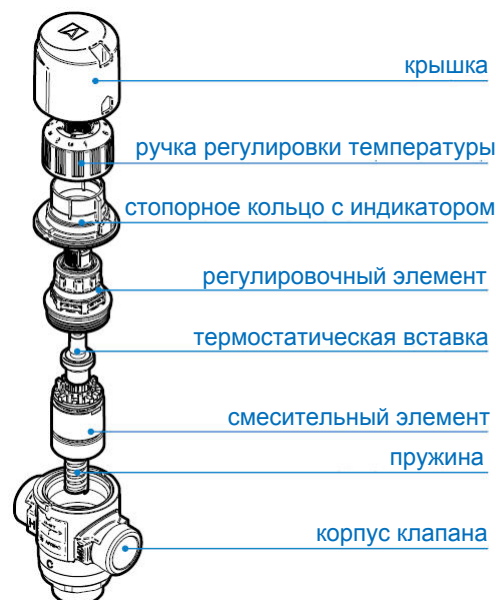
Рис. 2: Конструкция клапана ATM
