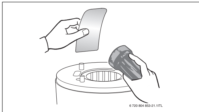
Рис. 62 Проверка наличия грязи в теплообменнике
