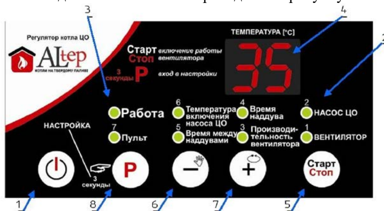
Рисунок 3 – Зовнішній вигляд передньої панелі контролера
