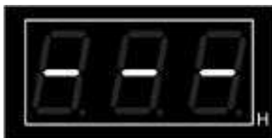
Рисунок 4. Показания индикатора при неисправности или отсутствии датчика температуры.
