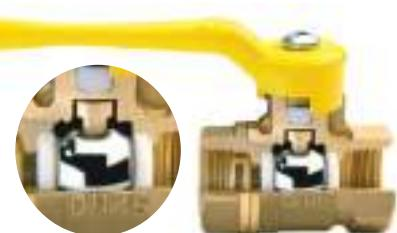
Материал корпусных деталей – латунь ЛС59-1 по ГОСТ 15527-2004. Материал шаровой заслонки – латунь ЛС59-1 по ГОСТ 15527-2004 с покрытием Н9Х.
