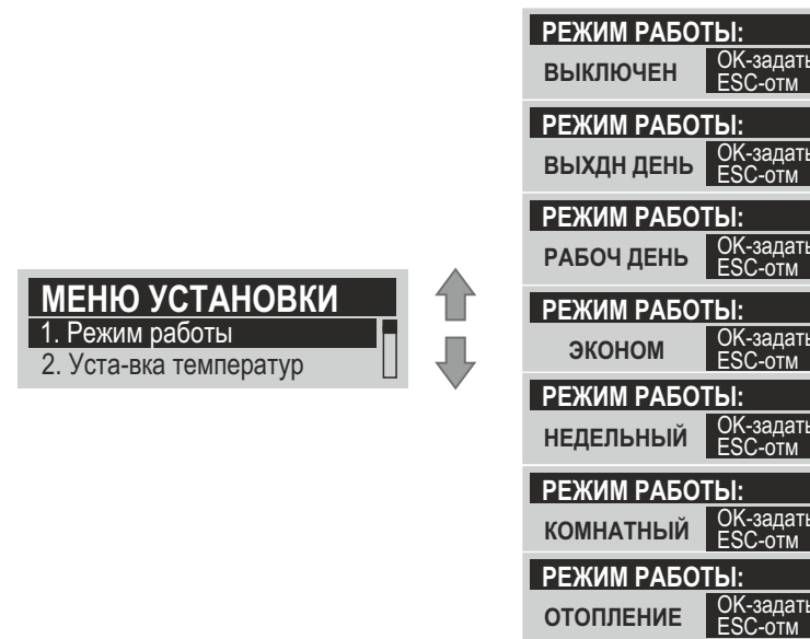
Рисунок 27. Отображение на экране режимов работы прибора.
