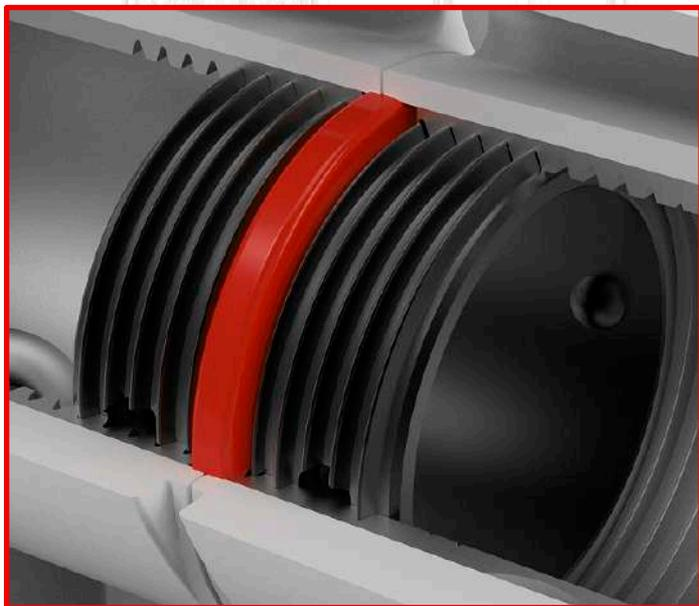
Секции имеют особое соединение типа "lock" с использованием усиленных nipples и прокладок из термостойкого эластомера EPDM формы "O-ring" .
