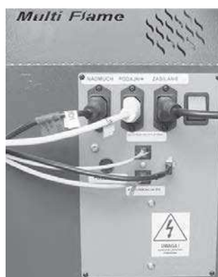
Рисунок 3 Модуль, контролирующий работу горелки
