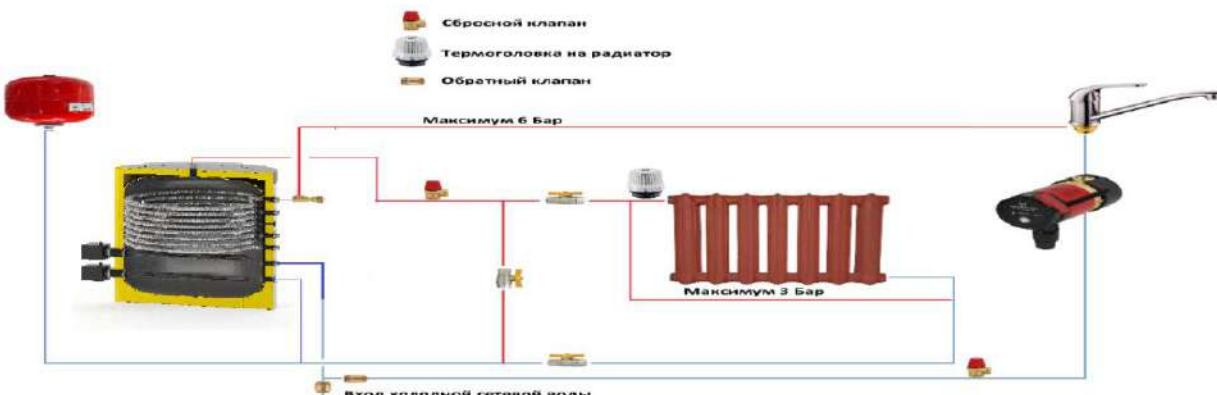
Схема с противоожоговым клапоном и рециркуляцией бака
