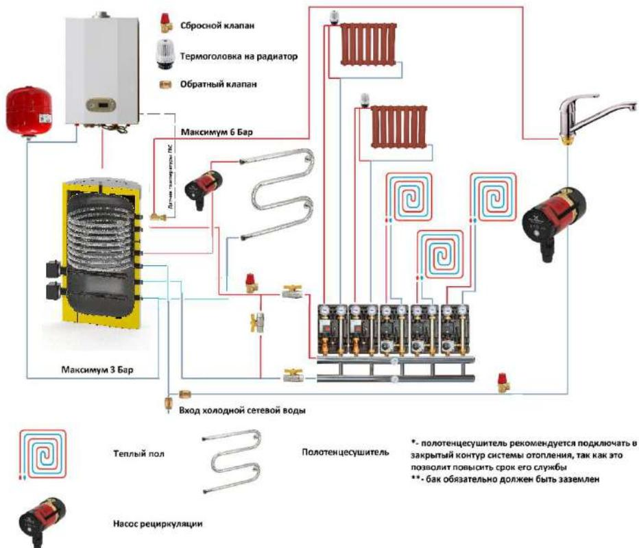
Данная схема реализована с применением возможности бака как гидравлического разделителя. Так же показаны различные возможности, связанные с подключением полотенцесушителя, рециркуляцией.
