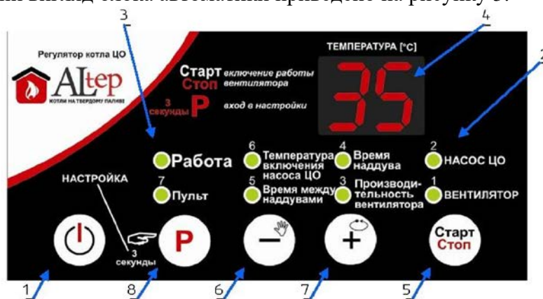
Рисунок 3 – Зовнішній вигляд передньої панелі контролера
