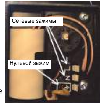
Рис. Подсоединение проводов к насосу Ц.О.
