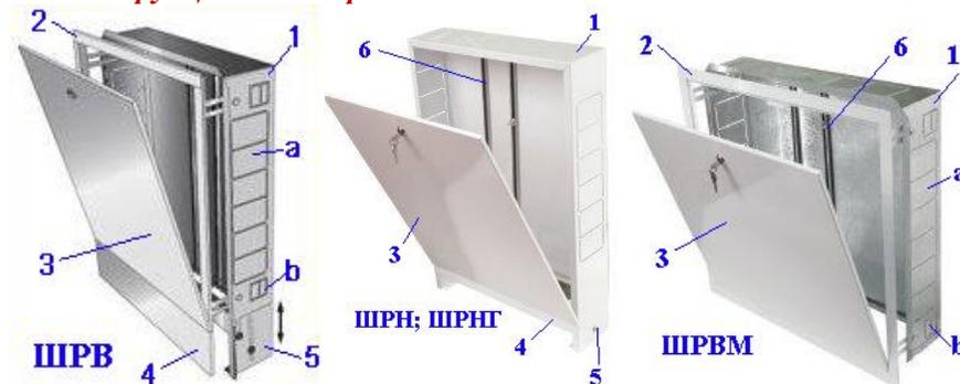
Детали шкафов выполнены из оцинкованной стали. Лицевые поверхности окрашены порошковой эмалью RAL9016 по фосфатной подготовке. В боковых стенках корпуса 1 выполнена перфорация «а», сегменты которой удаляются в месте, удобном для пропуска присоединительных трубопроводов. Выдвижная рамка встраиваемых шкафов позволяет регулировать глубину от 125мм до 195 мм.
