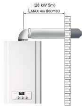
Горизонтальная система дымоудаления (Lмакс. расстояние с одним коленом: 4 м, Ø60/100) (Lмакс. расстояние с одним коленом: 6 м, Ø80/125)
