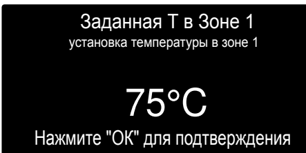
Изменение температуры горячей воды отопления
