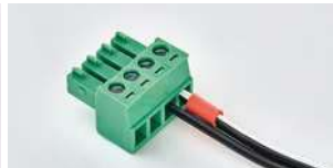
Фото 19. Подключение внешнего блока питания +12 В к ответной части разъема электропривода
