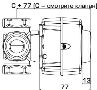
Размеры установки для приводов серии ARA600 со смесительными клапанами ESBE VRG100, VRG200, VRG300, VRB100 и VRH100
