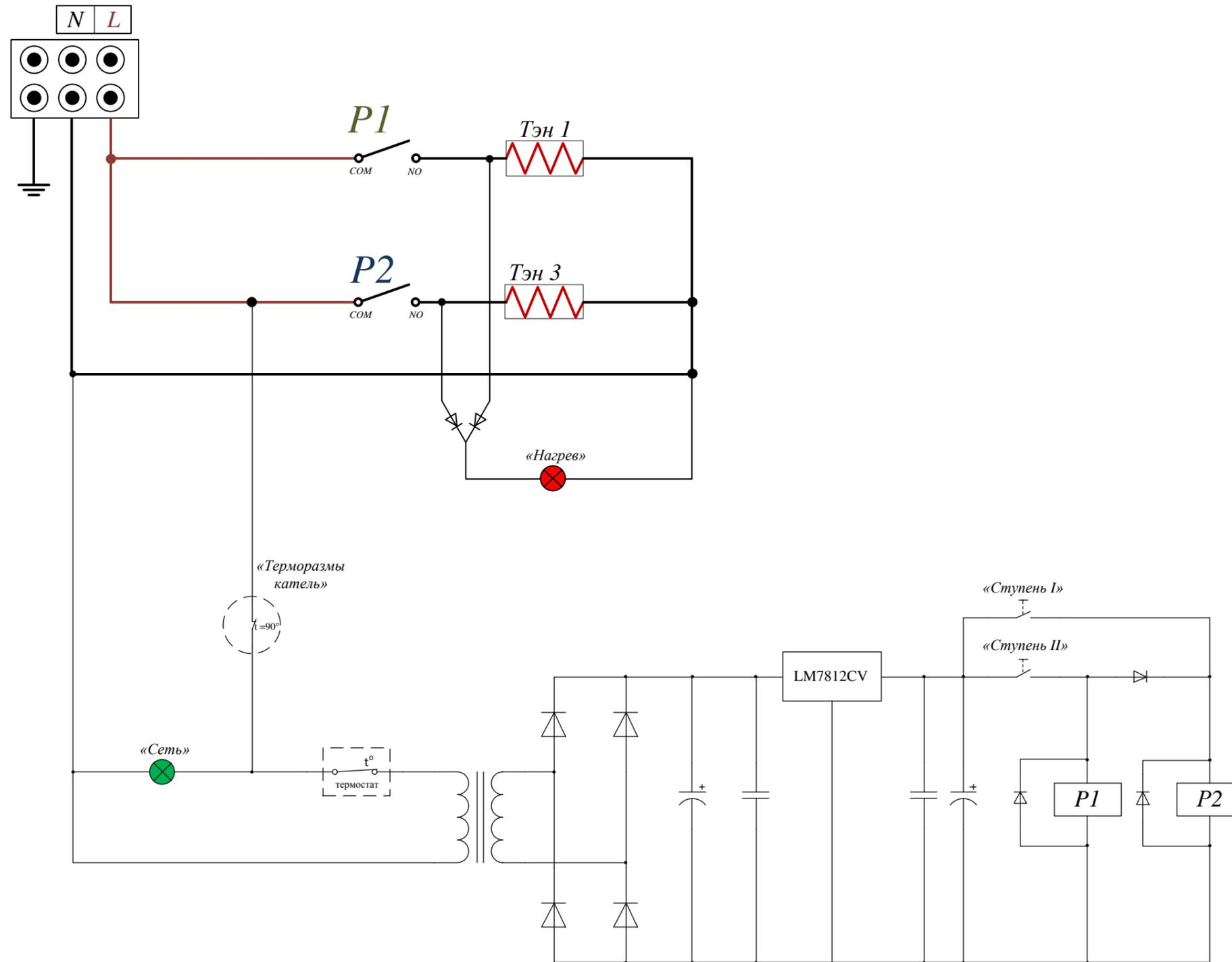
Рисунок 4 – Схема электрическая принципиальная для котлов «Mini»
