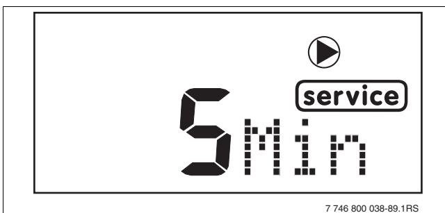
Рис 50 Показания на экране: «время выбега насоса»
