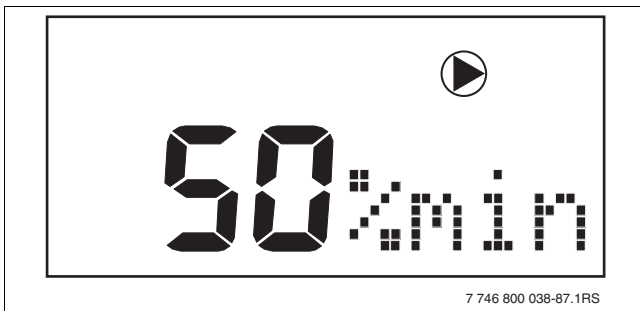
Рис 49 Показания на экране: «модуляция насоса»
