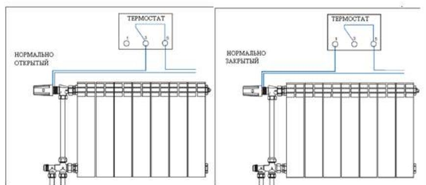
4.7. Нормально закрытый привод при отсутствии напряжения закрывает терmostатический клапан. При подаче напряжения клапан открывается (рис.6).
