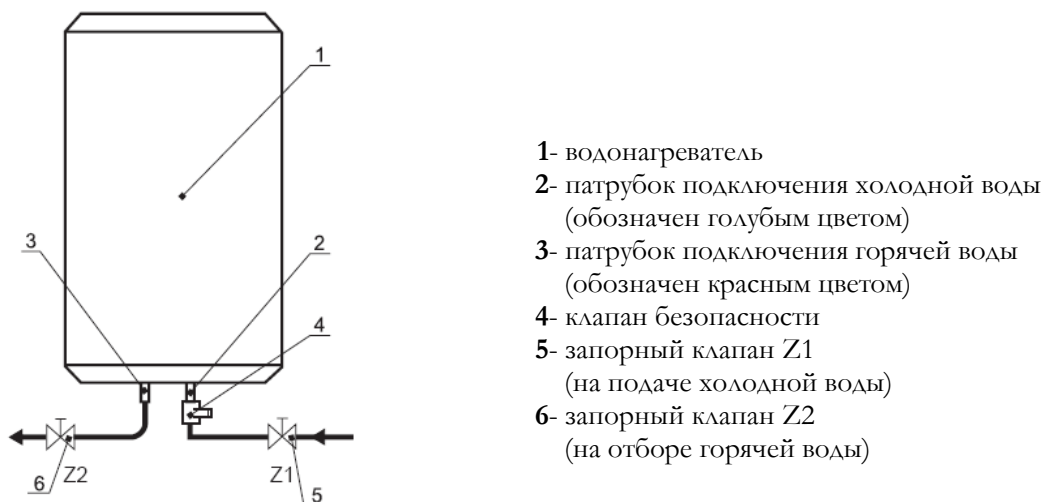
Рис.2 Схема подключения водонагревателя к водопроводной сети
