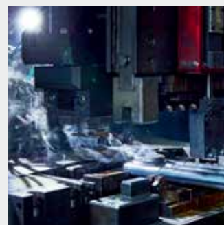
Сварка коллекторов с трубами
