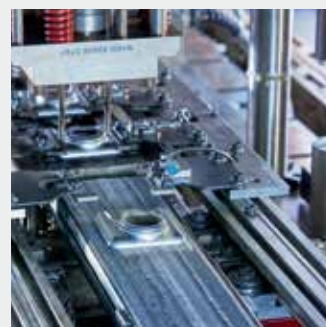
Точное изготовление половинок коллекторов
