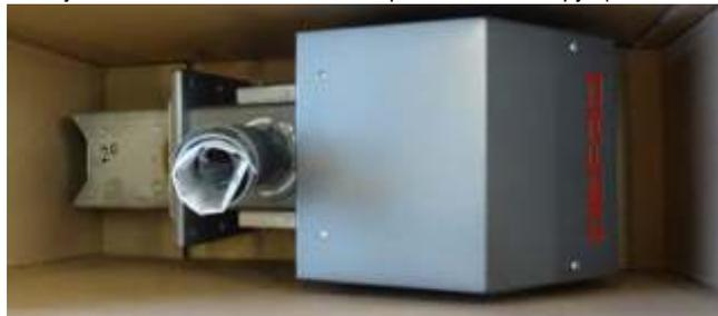
ШАГ1. Удалить горелку из картонной упаковки. Если горелка находилась в течение некоторого времени при низкой температуре, перед подключением необходимо выдержать до достижения температуры помещения. Это необходимо, чтобы избежать поломок устройства в результате образования конденсата на электронных компонентах уст-ва.
