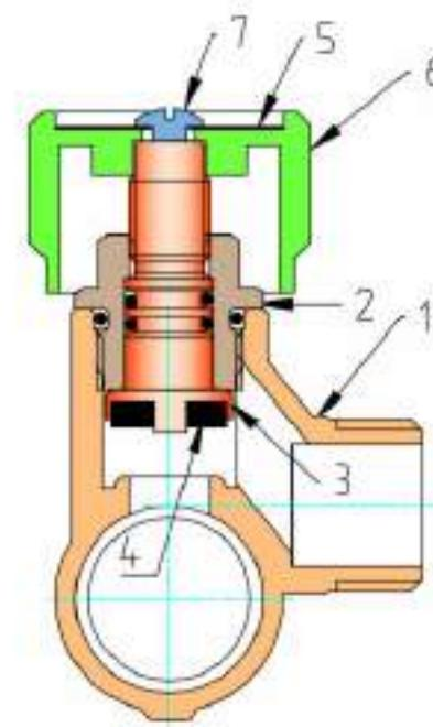
Коллектор состоит из латунного никелированного корпуса 1, имеющего на концах присоединительные резьбы (с одной стороны внутреннюю, с другой наружную) и встроенных в корпус регулировочных вентилей.
