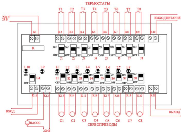
4.2.4. Комнатные термостаты T1-T8 подключаются к клеммным колодкам K2-K9.
