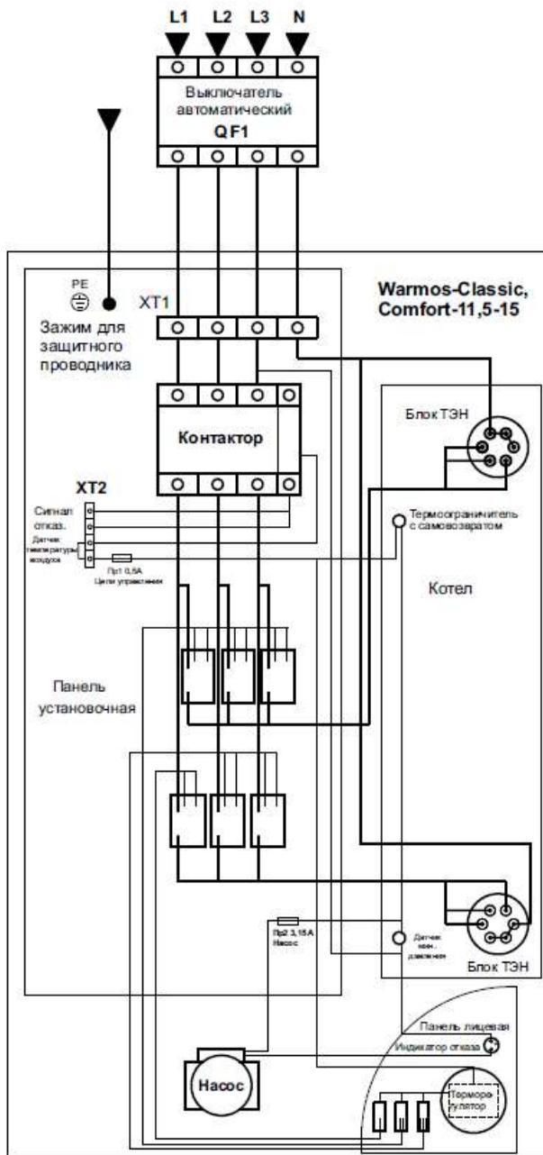
**Рисунок 7.** Подключение приборов Warmos CLASSIC, Warmos COMFORT – 11,5-15 кВт
