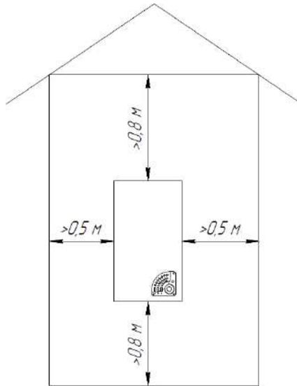
Рисунок 3. Схема установки
