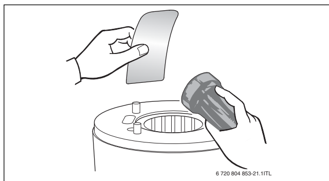
Рис. 52 Проверка наличия грязи в теплообменнике
