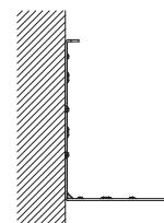
**Внимание!** Тип 10: расстояние от стены 50 мм / тип 11 – 33: расстояние от стены 30 мм
