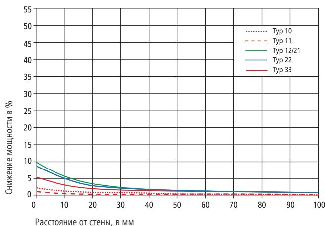
**Внимание:** Ожидаемое понижение мощности не является потерей мощности. Просто греющие поверхности не могут беспрепятственно отдавать своё тепло. Следствием является повышение температуры теплоносителя в обратной линии.
