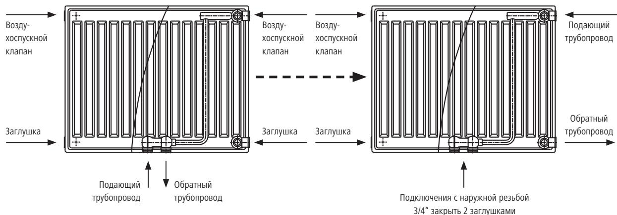
**Запомните:** Вентильный радиатор с правосторонним расположением вентиля с обратной линией справа при использовании в качестве компактного радиатора
