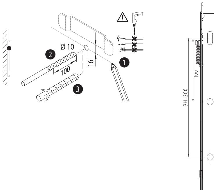
**Внимание!** Крепёжный материал обладает грузоподъёмными свойствами. Тем не менее, необходимо проверить крепёж и способ крепления на месте установки и подобрать его, в случае необходимости, с учётом конкретной монтажной ситуации! Для повышения несущих способностей можно использовать третий болт и дюбель.
