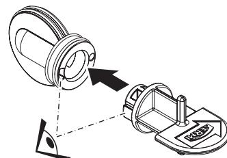
2. Проверить правильность положения разделительной пробки и монтажного ключа:
