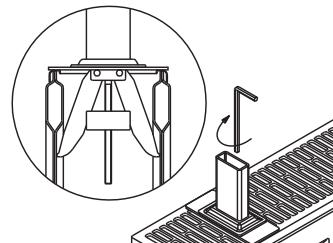
„Держатель вверху“ (B) вставить в опору (C) и установить необходимую высоту. Зажимный винт (H) затянуть с усилием 3-4 Нм.
