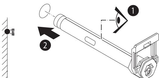
**Внимание:** При наличии на стене защитно-изоляционного слоя максимальный отступ от стены сокращается на толщину этого слоя (см. рисунок ниже); Область разводки кронштейна не должна находиться полностью в полости строительного материала, использованного для возведения стен.
