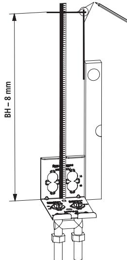
13. Просверлить отверстия для крепления и провести монтаж настенного крепления согласно прилагаемому руководству по монтажу.
