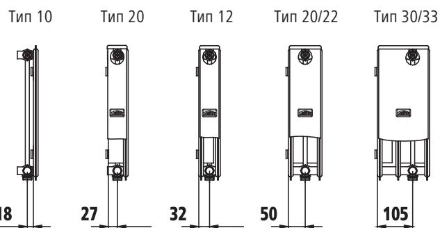
9.2 Размеры подключения радиатора с подключением по центру FTV/PTV/PLV
