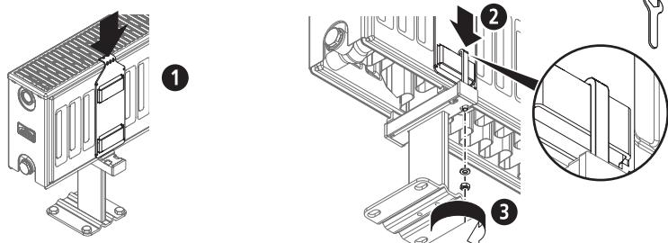
6. Выровнять радиатор по горизонтали, установочные винты затянуть для горизонтальной фиксации (10 Нм)
