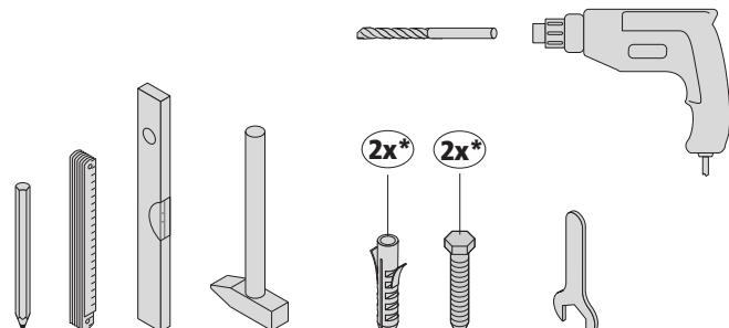
\* Выбрать болты и дюбели в зависимости от строительного материала стены (не включены в комплект универсального шаблона монтажа).
