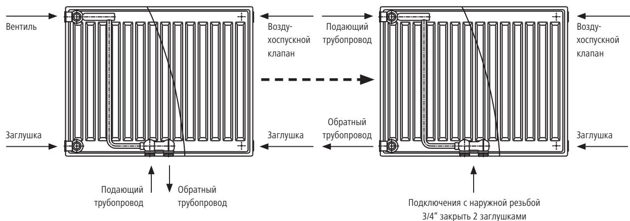
**Запомните:** Вентильный радиатор с левосторонним расположением вентиля с обратной линией слева при использовании в качестве компактного радиатора
