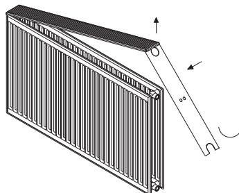
Затем поднять с одной стороны и сдвинуть верхнюю планку, чтобы отсоединить её от второй боковой планки.
