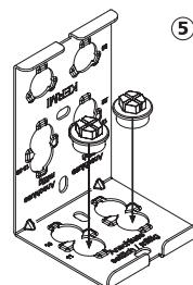
11. Без использования инструмента, вручную, привинтить резьбовое соединение к соединительным пробкам (B).
