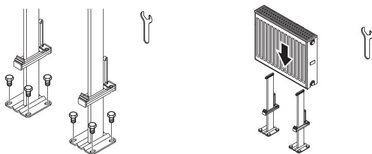
4. Закрепить консоль с радиатором, затягивая гайку на крюке
