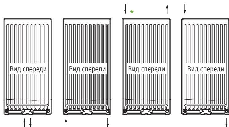
\* Внимание: При подключении сверху снижение мощности до 15%.
