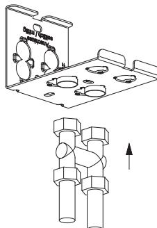
**Внимание!** Соединение "соединительная пробка (B) и резьбовое подключение" не является герметичным. Испытание давлением возможно только с запираемыми резьбовыми соединениями.
