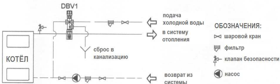
Рис.3 Схема системы с двухходовым клапаном безопасности DBV1.
