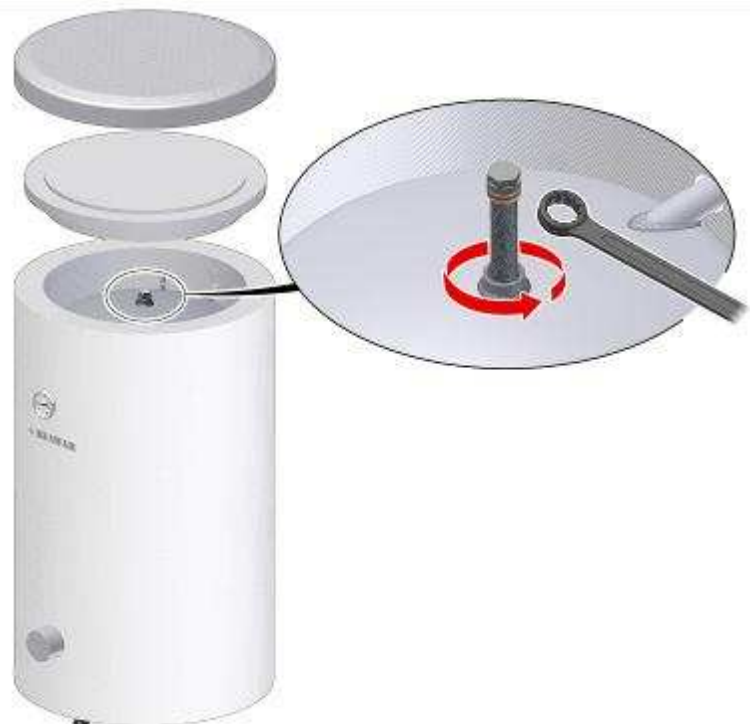
Рис. 8 Замена магниевого анода
