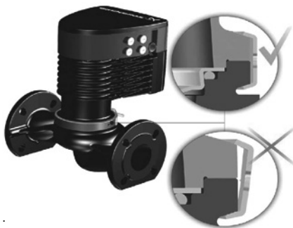
Рис. 16 Закрепление головной части насоса на корпусе насоса
