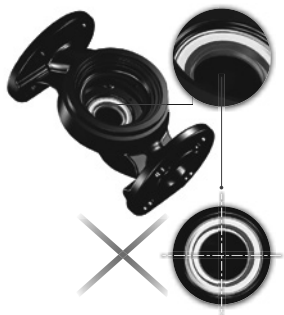
Рис. 16 Неправильно выровненная система уплотнений
