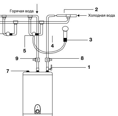
Рис. 4а: Схема подключения к водопроводу моделей серии Rival U
